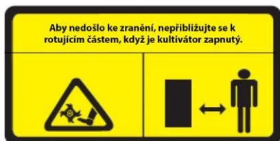
Aby nedošlo ke zranění, nepřibližujte se k rotujícím částem, když je kultivátor zapnutý.
