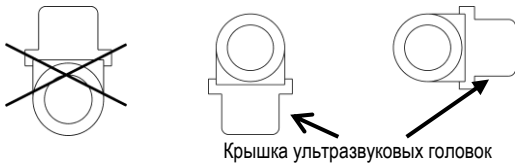
Рис. 6: Положение при встраивании для учета энергии охлаждения / холода
