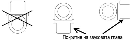
Фиг. 6: Препоръчително монтажно положение за студомер
