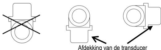
Afb. 6: Aanbevolen montagepositie bij koudemeting
